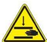
Para evitar lesiones graves por aplastamiento o amputación, no trabaje con el equipo sin las protecciones de seguridad instaladas en las partes móviles.
